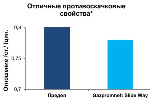
Масла серии Gazpromneft Slide Way предотвращают прерывистое скольжение направляющих и кареток, обеспечивая высокую точность обработки.
